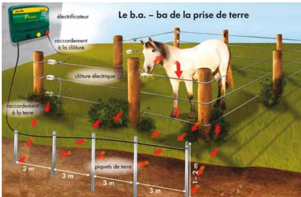
Le système de prise de terre typique pour un électrificateur. Veillez à avoir une prise de terre parfaite, car, dans 80% des cas, les systèmes installés sont insuffisants.
