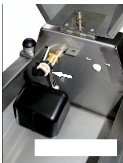
en Inox , convenant à tout Modèle Vidage Express. Ce tuyau est alimenté par l'eau tiède provenant du réchauffeur d'eau. Ce système maintient l'eau hors gel et protège la canalisation.
