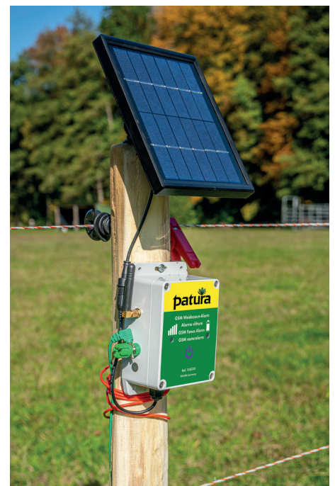
Placer l'alarme GSM en fin de clôture afin d'assurer une surveillance complète du pâturage
