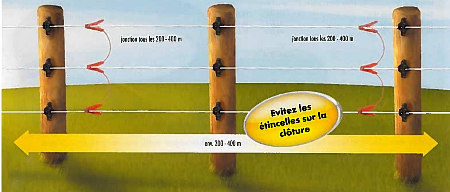
Il est conseillé de connecter les fils transversalement à intervalles réguliers de 200 - 400 m. Les débuts et fins de ligne ainsi que les coins sont les meilleures endroits pour ces jonctions.
