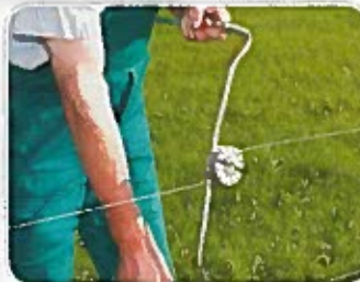
Tournez jusqu'à ce que la bonne tension soit obtenue
