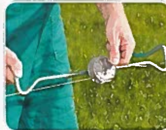
Accrochez la clé sur le fil, insérez l'épingle et enlevez la clé
